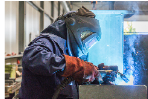
Lasser die overdrukhelm met aangedreven filter gebruikt
